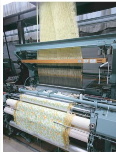
デザインした文様をデータ化しジャカード織機を制御稼働する
