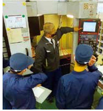
マシニングセンタを使ってアルミ材を加工します。
