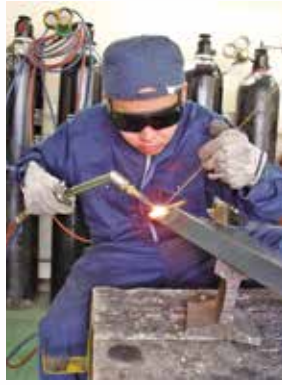
ガス溶接では金属を溶かして接合します。
